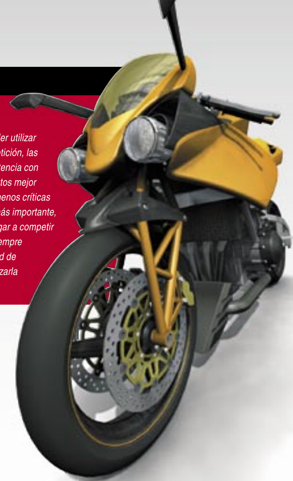
La apuesta por la suspensión frontal alternativa es común en los dos prototipos españoles que traemos a estas páginas. Entre los modelos de serie del mercado actual, sólo BMW se atreve a explorar este campo con sus sistemas Telelever y Duolever.
